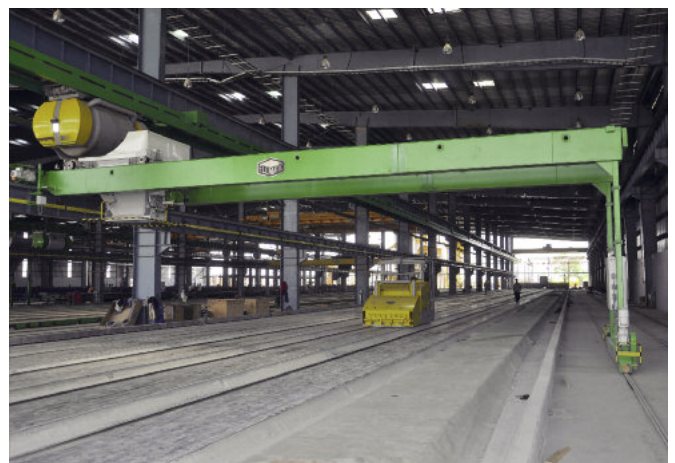
Linia technologiczna do produkcji płyt kanałowych z zautomatyzowanym systemem podawania mieszanki betonowej.
