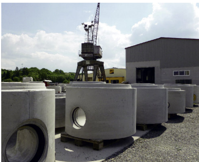
Zaledwie po roku od uruchomienia systemu Perfect Werra-Baustoffwerk wytwarza w tej technologii ponad połowę podstaw studni.
