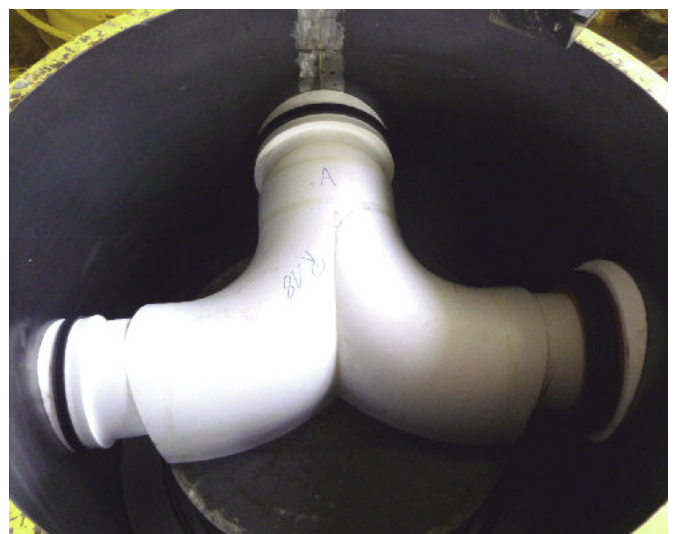
Mocowanie dokładnego negatywu kinety w formie – wraz z kształtkami formującymi przyłącza z wstępnie zamontowaną uszczelką.
