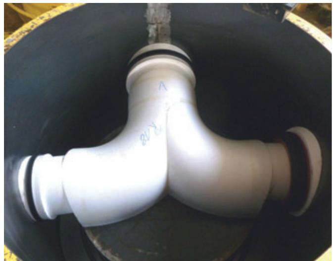
*L'attrezzaggio delle casseforme – idealmente con stampi dotati di guarnizioni premontate – è l'ultimo passaggio della preparazione dei negativi dei canali eseguiti con la massima precisione*
