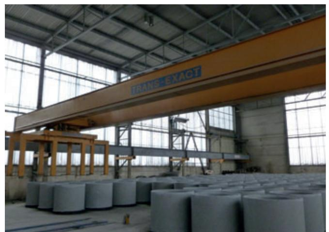
Una gru robot è il componente centrale dell'impianto ad alto livello di automatizzazione per la produzione di pozzetti installato all'inizio degli anni Novanta.
