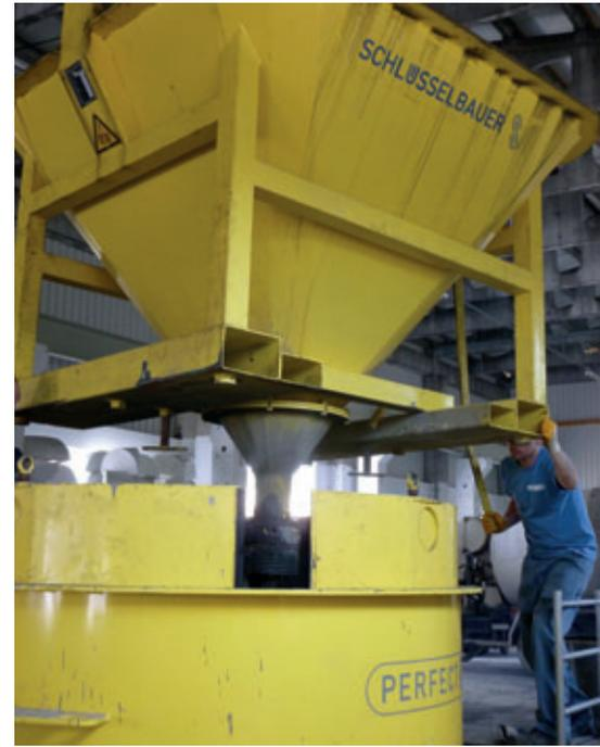
*Per la produzione dei fondi per pozzetti Werra utilizza calcestruzzo da trasporto portato agli stampi in acciaio tramite gru a ponte e benne per cemento*
