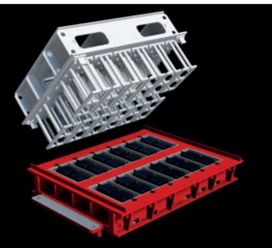
Modello del stampo per blocchi cavi carbo di Kobra per Dubai Blocks
