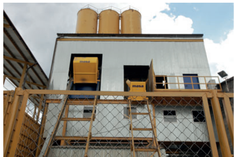
Fig. 1 + 2: Con il nuovo impianto di miscela e dosaggio Masa si alimentano due miscelatori S350/500 e PH 1500/2250
