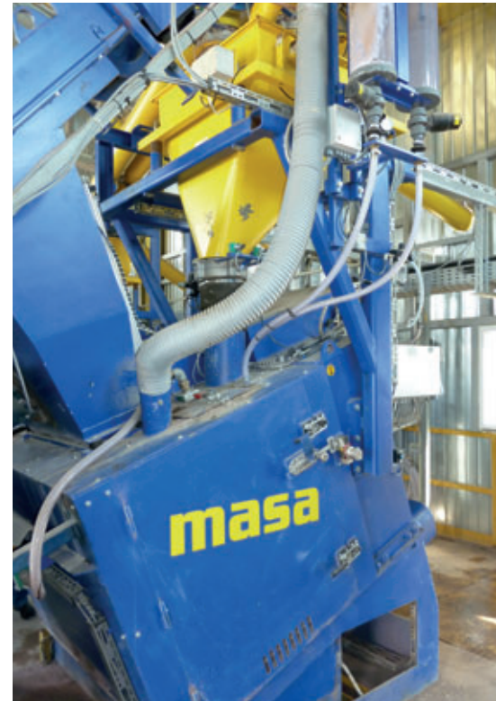
Fig. 3: Il nuovo miscelatore Masa S350/500 nello stabilimento della società Magik Ltd. in Ucraina
