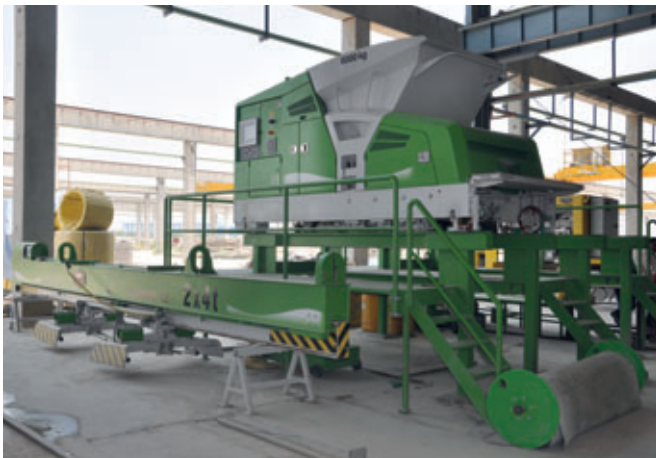
Estrusore E9 e traversa di sollevamento
