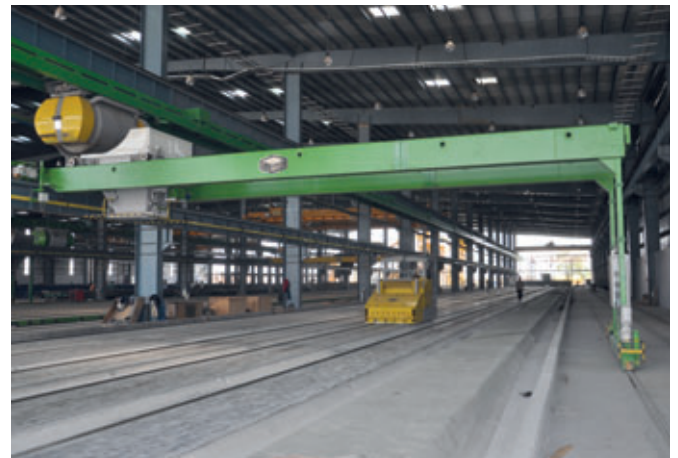
Produzione di solai alveolari precompressi con distribuzione del calcestruzzo automatizzata
