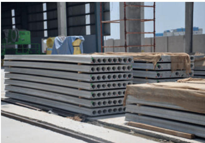
Solai alveolari precompressi e pareti nel magazzino del materiale
