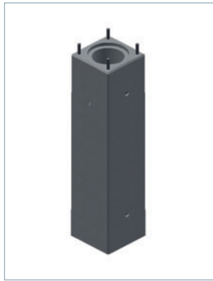
Fondation pour pylônes de caténaires sans pied
