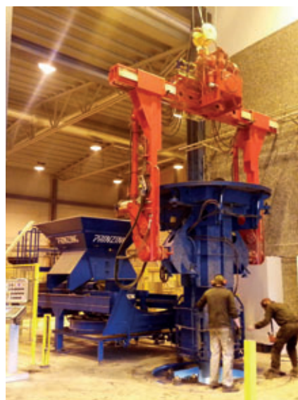
Installation Atlas avec palonnier de retournement
