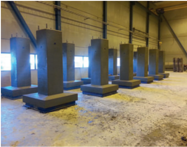
Blocs de fondation avec pied
