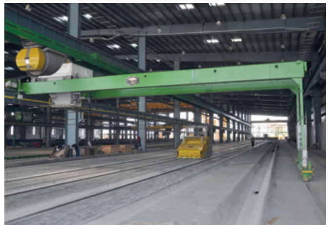
Production de dalles alvéolées avec distribution automatisée du béton
