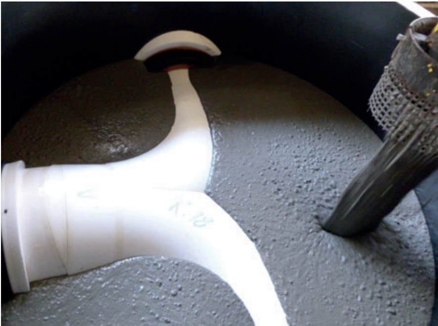
Coulage de fonds de regards Perfect dans les moules – réalisation des éléments « monobloc » en démoulage différé
