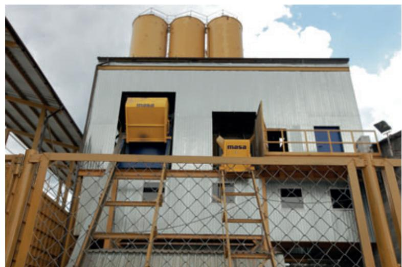
Fig. 1 + 2: Con la nueva instalación de mezcla y dosificación de Masa se alimentan dos mezcladoras S350/500 y PH 1500/2250
