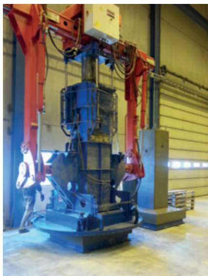
Desencofrado en la estación de curado
