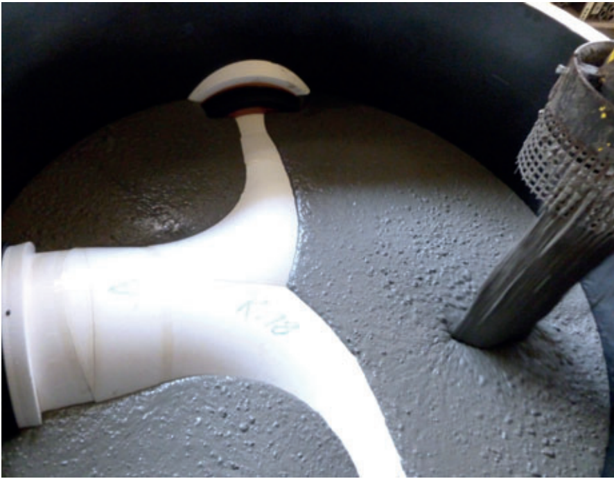
Hormigonado de bases de pozos Perfect en moldes de fundición: fabricación de los componentes endurecidos en encofrado "en una sola pieza"
