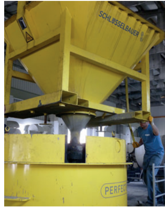
Para la fabricación de bases de pozos en la planta de Werra-Baustoff se utiliza hormigón preparado que se transporta hasta los moldes de acero por medio de una vía de grúa y cubiletes para hormigón
