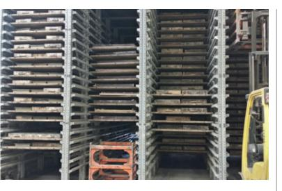
Se consideró que la solución con el sistema de estanterías prefabricado era el mejor método, ya que permite almacenar un número muy elevado de productos en una superficie pequeña, cabía en una de las tres cámaras de curado existentes y además se podía montar rápidamente.
