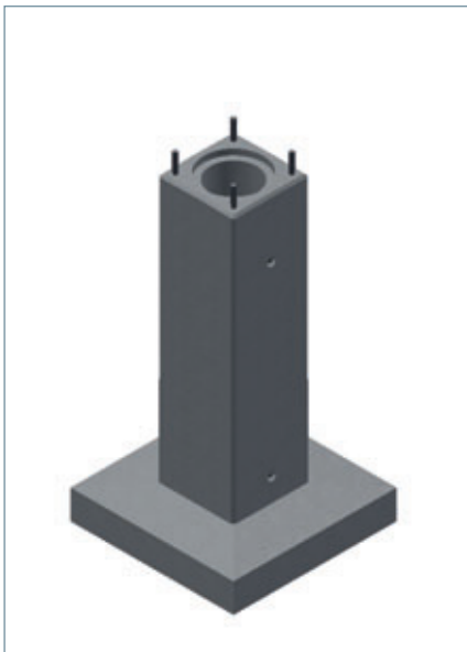
Fundament für Fahrleitungsmasten mit Fuß
