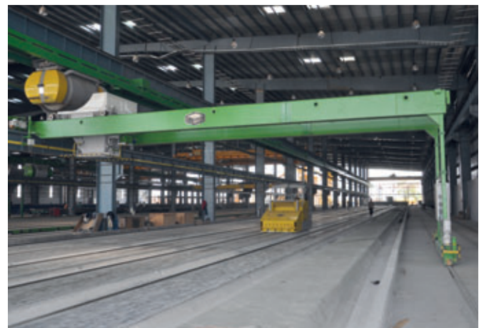
Spannbetonfertigdeckenproduktion mit automatisierter Betonverteilung
