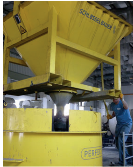
Für die Schachtunterteilfertigung wird im Werra-Baustoffwerk Transportbeton eingesetzt, der mittels Kranbahn und Betonkübel zu den Stahlformen gebracht wird.
