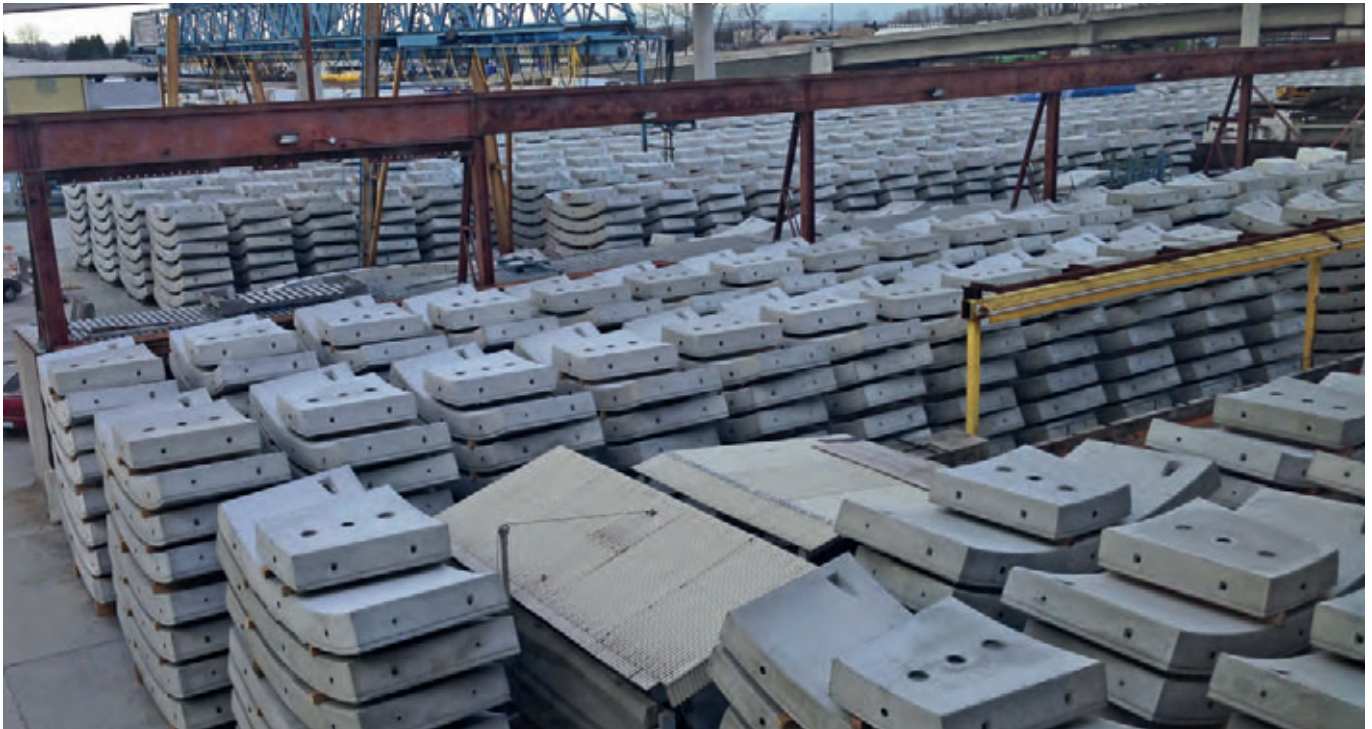
На складе APS в Лэнгли хранятся изготовленные на данный момент 3504 сегментов для 438 звеньев
