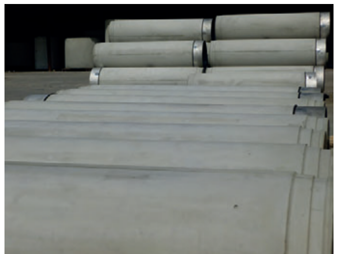
С 2014 г. на заводе в Штэльпхене выпускаются трубы Perfect Pipe для укладки способом продавливания
