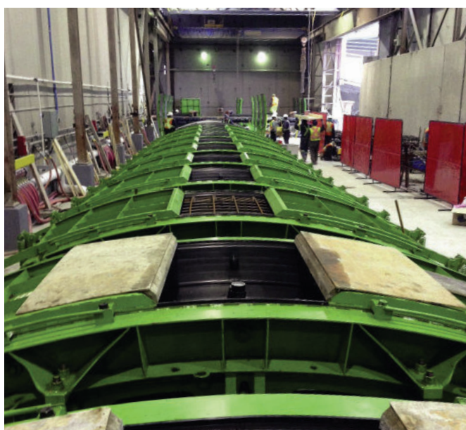
Formy do produkcji elementów tunelowych wyczyszczone i gotowe do napełnienia mieszanką betonową. Formy są napełniane 2 razy dziennie, co umożliwia wyprodukowanie 48 segmentów, czyli 6 pierścieni dziennie.
