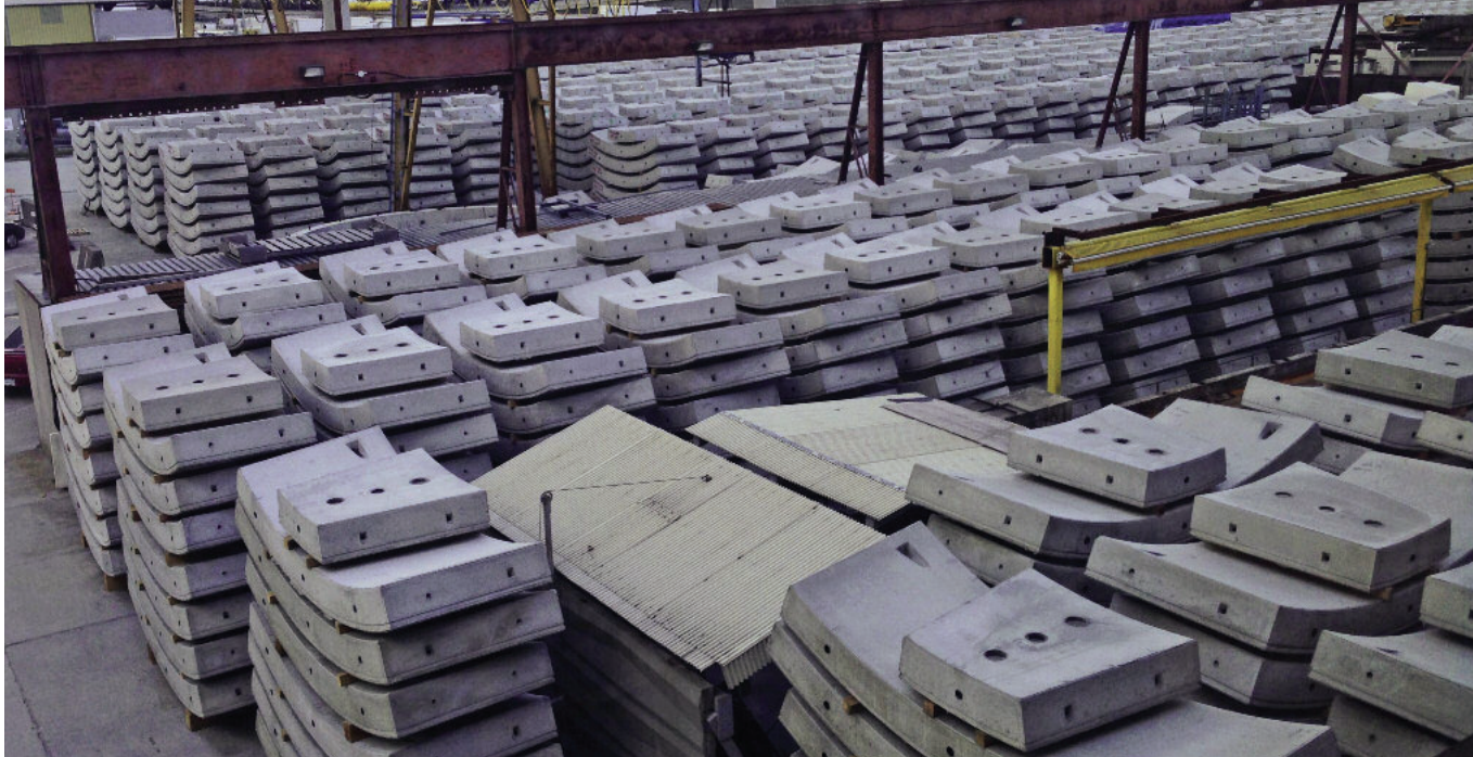
Plac składowy firmy APS w Langley z częścią 3504 segmentów / 438 pierścieni wyprodukowanych do tej pory.
