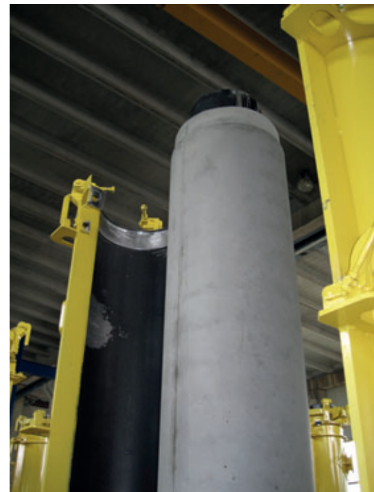
I tubi in calcestruzzo colato vengono armati e quindi prodotti con tolleranze minime
