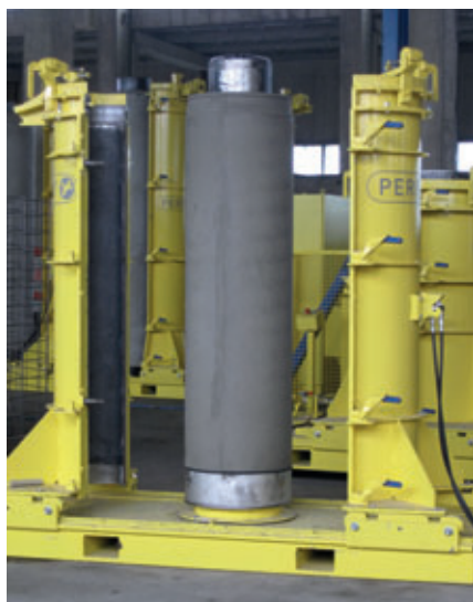
Per un progetto in corso vengono prodotti tubi di sollevamento Perfect Pipe con diametro nominale DN300 e lunghezza 2 m
