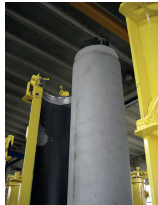
Les tuyaux en béton fluide sont fabriqués en durci moule pour satisfaire aux tolérances les plus strictes
