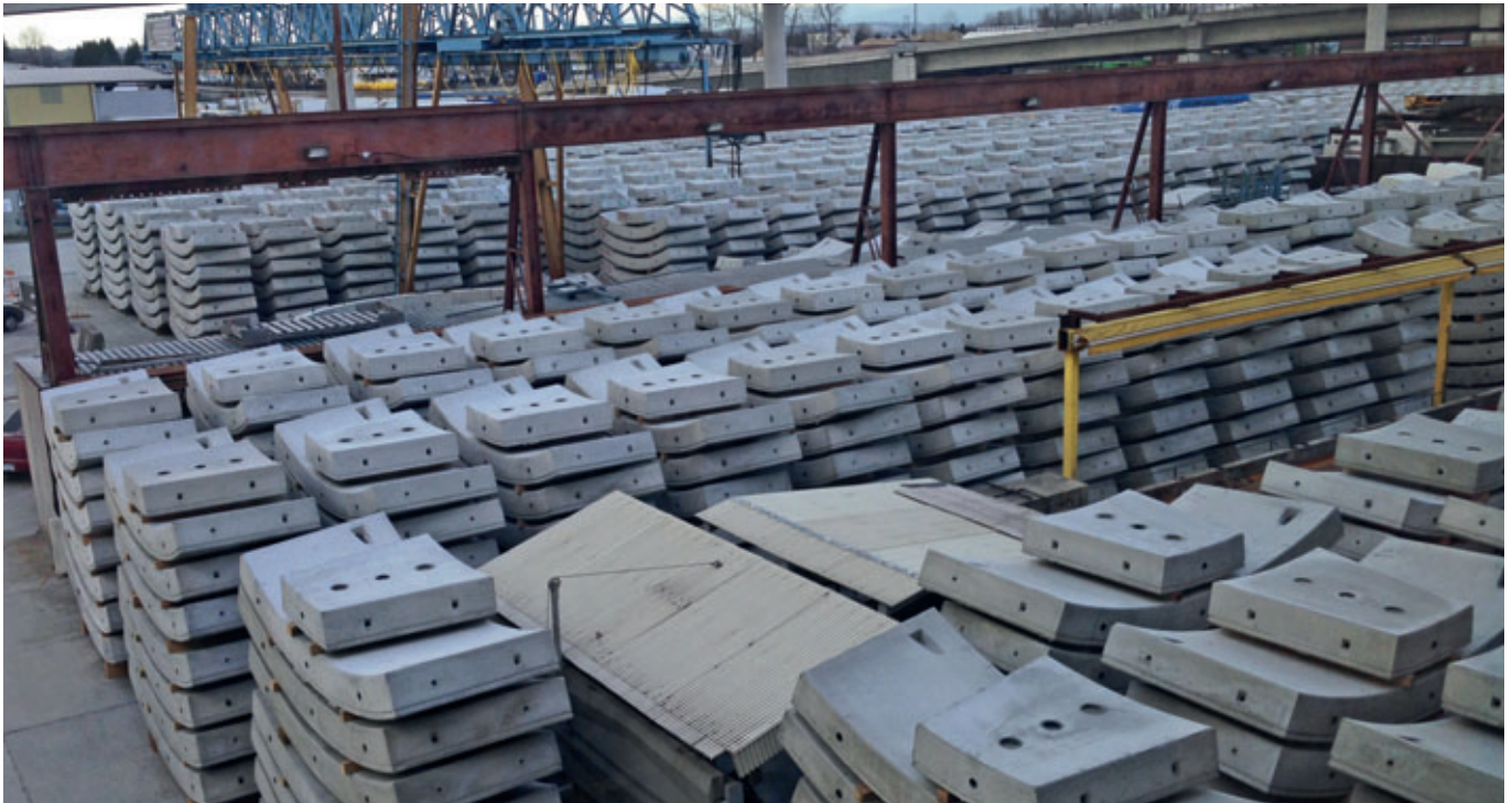
Im Lagerbereich von APS' Langley sind einige der 3.500 Tübbings zu sehen, die bisher gegossen wurden.
