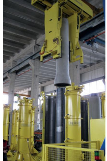
Der Beton wird mit Mischwägen zur Vortriebsrohrfertigung und über einen Küberl in die Formen eingebracht.
