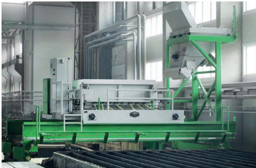
Lider Prom 的很多预制构件产品都是由 Elematic 公司的机器和设备生产的。最近引入的设施是一条全新的桩基生产线。Elematic 的桩基铸造机用于模具的铸造。铸造机与模具同步运动，将混凝土注入模具中，再由振动打桩机压紧浇筑混凝土
