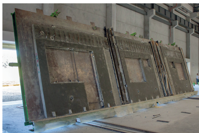
Сборные железобетонные фасадные элементы на поворотном столе
