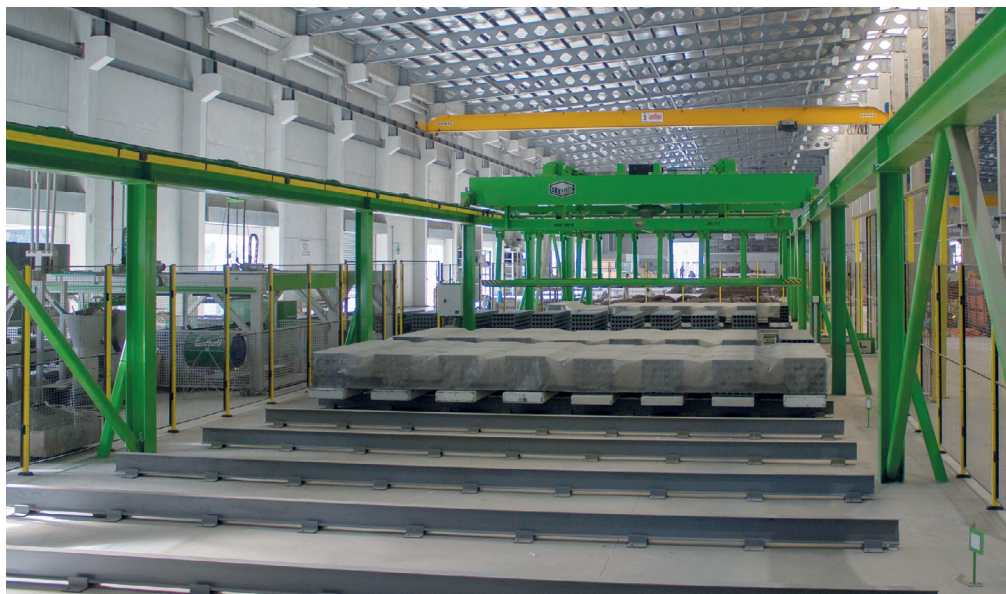
Производственная линия Ascotес на заводе DDT с автоматизированной системой предпросушки
