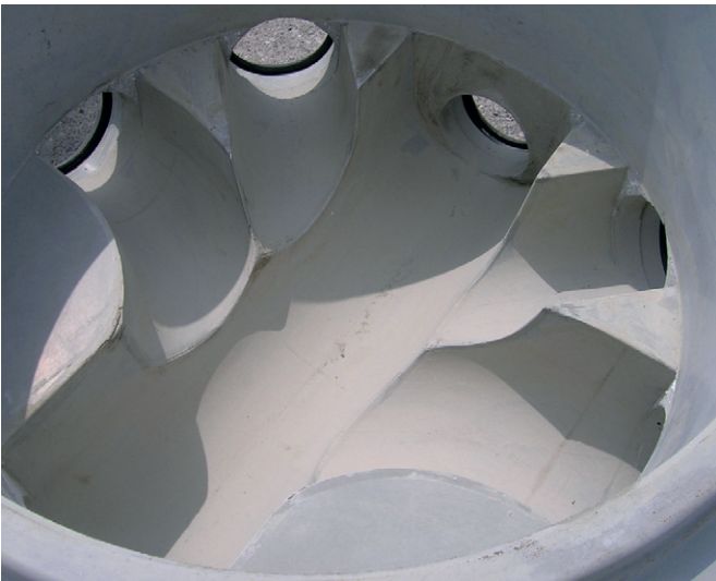
Система Perfect позволяет с легкостью изготавливать лотки даже со сложной геометрией
