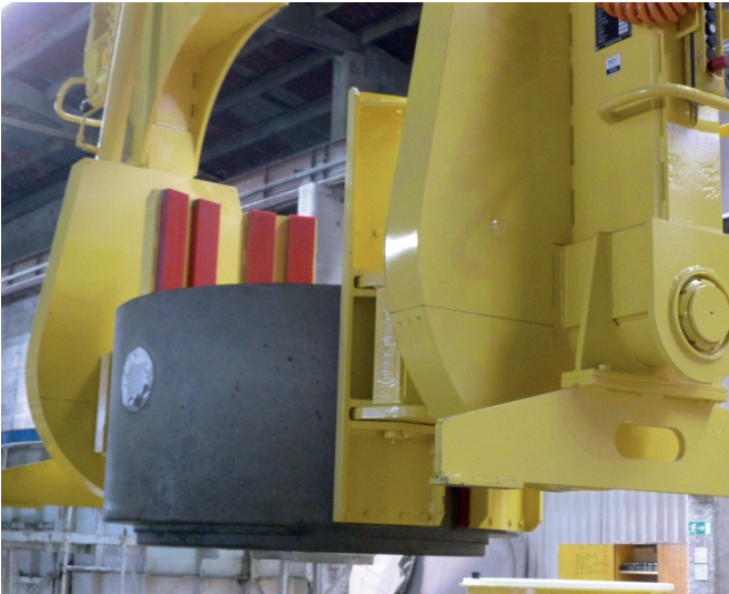
Первое днище колодца Perfect, изготовленное на заводе Tiba
