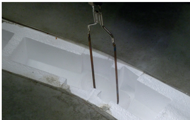
Продуманная конструкция матриц облегчает распалубку и сокращает объем вторичной переработки
