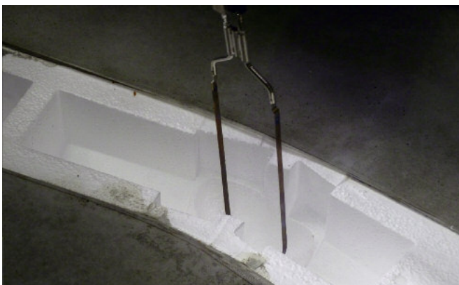
Inteligentnie zaprojektowane kształtki ułatwiają usuwanie polistyrenu i redukują ilość materiału przeznaczonego do recyklingu.
