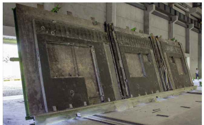
Prefabrykowane płyty fasadowe na stole uchylnym.
