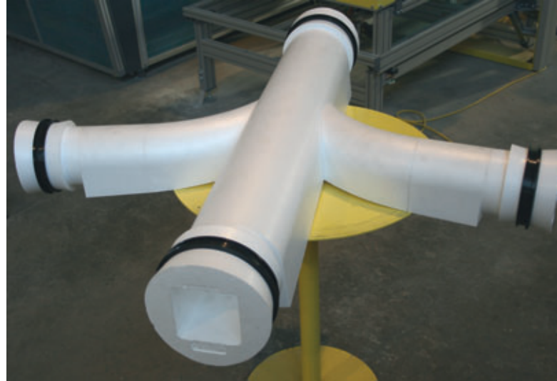
Esempio di uno stampo negativo di un canale realizzato con stampi in EPS Perfect
