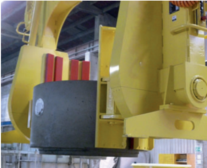
Il primo pozzetto realizzato da Tiba con il processo Perfect
