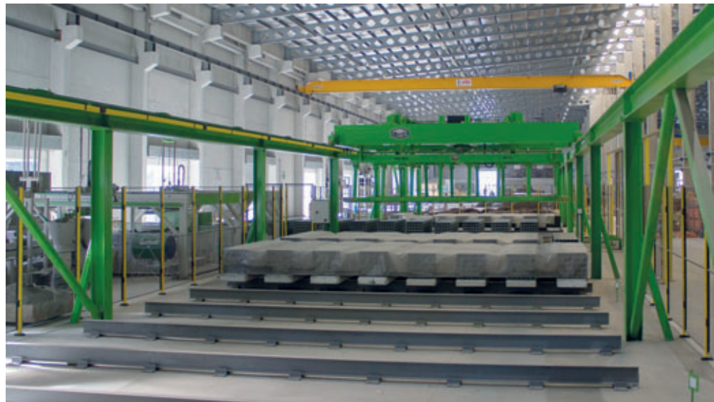
Linea di produzione Acotec con magazzino automatico di pre-maturazione presso DDT
