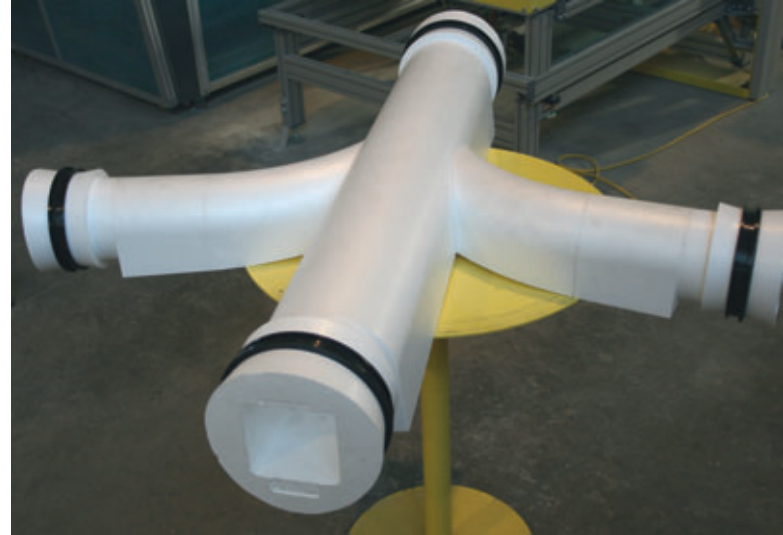
Exemple de moule négatif de cunette réalisé à partir de matrices EPS Perfect.
