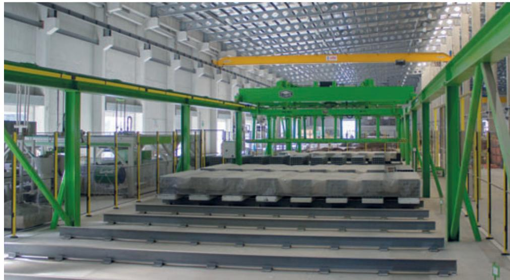
Línea de producción Acotec con depósito de fraguado previo automático en DDT
