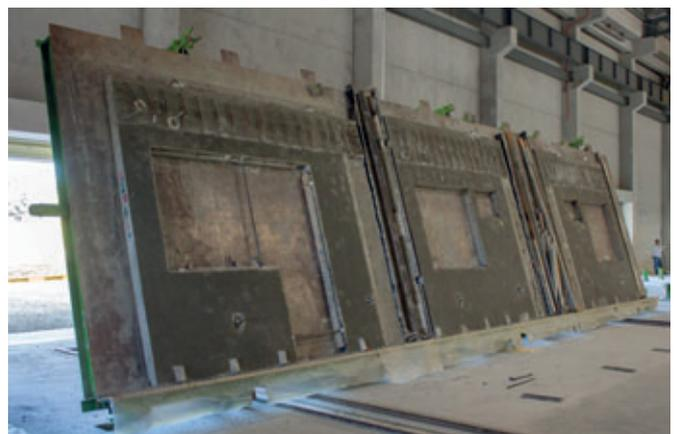
Fachadas prefabricadas en la estación de volteo
