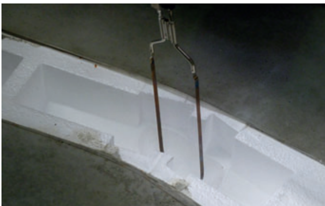
La construcción inteligente de piezas moldeadas facilita el desencofrado y reduce el volumen de material de reciclaje
