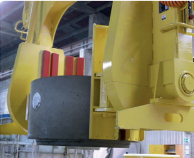
1. Base de pozo Perfect realizada por Tiba
