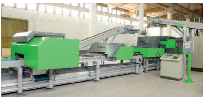
Центром линии Acotec служат стационарный экструдер и распиловочная установка для резки изделий
