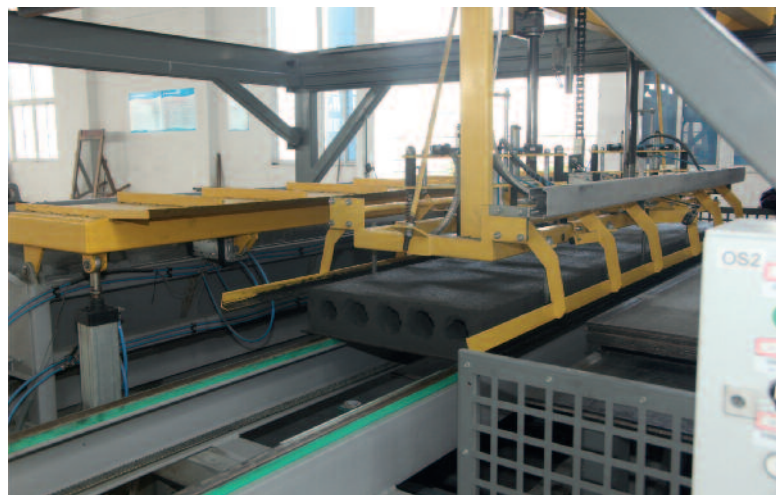
На станции штабелирования линии Acotec свежие панели укладываются на поддон по 6-10 штук для последующей выдержки
