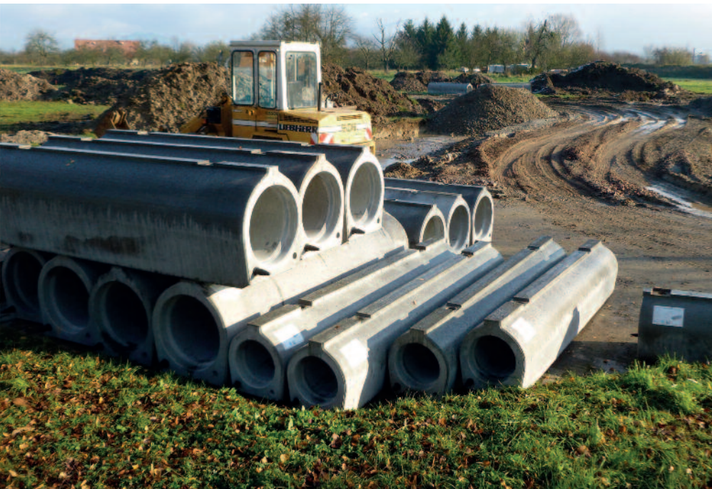
Эта технология позволяет изготавливать как композитные бетонно-пластиковые трубы, так и традиционные железобетонные трубы с плоской подошвой
