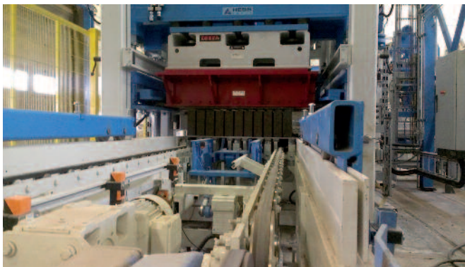
Высокопроизводительная установка Hess RH 1000-2 с электрической тележкой для замены форм
