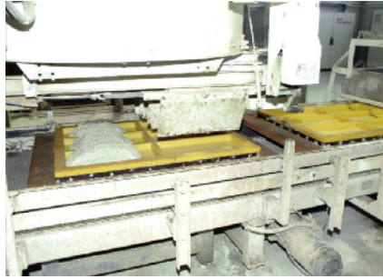
Produkcja elementów w technologii monolitycznej w zakładzie firmy ABW za pomocą nowych form firmy Wasa.
