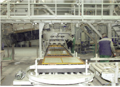
Produkcja elementów w technologii monolitycznej w zakładzie firmy ABW za pomocą nowych form firmy Wasa.
