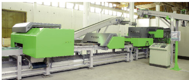
Sercem linii Acotec jest stacjonarny ekstruder wraz z piłą, która na bieżąco przycina płyty do odpowiedniej długości.
