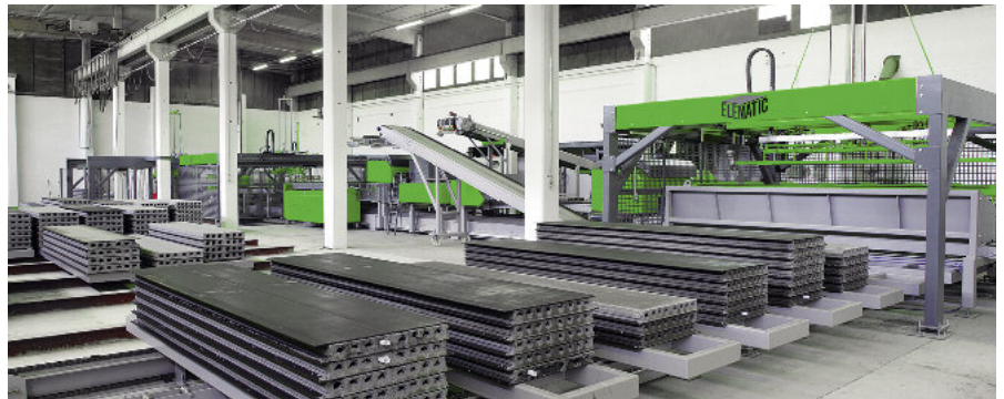
Stosy świeżych płyt Acotec w drodze do obszaru składowania, w którym są przechowywane przez noc.
