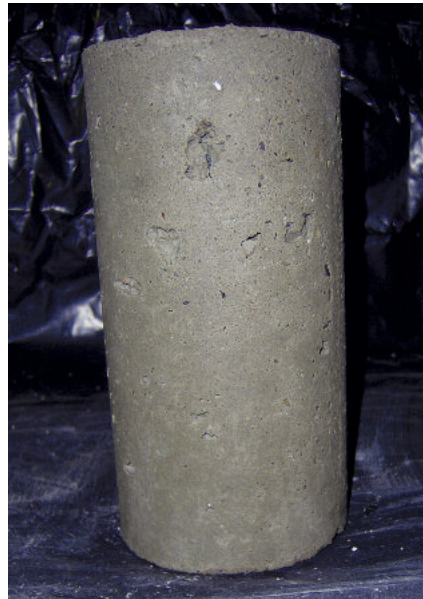
3. Próbkę zawierającą spoiwo ekkomaxx po 112 dniach przechowywania w roztworze H_2SO_4 o stężeniu 7%.
