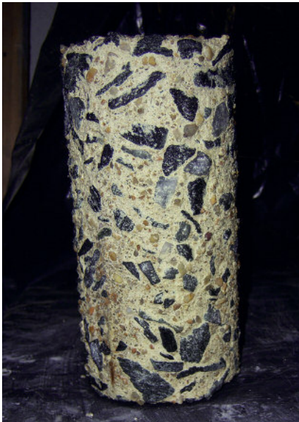
2. Próbkę zawierającą cement portlandzki po 112 dniach przechowywania w roztworze H_2SO_4 o stężeniu 7%.
