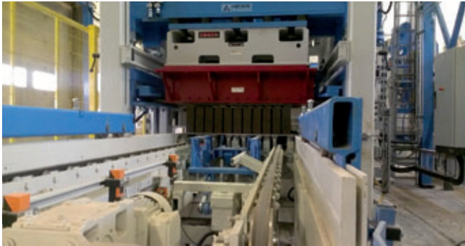
Macchina ad elevate prestazioni Hess RH 1000-2 con carrello elettrico di cambio stampi
