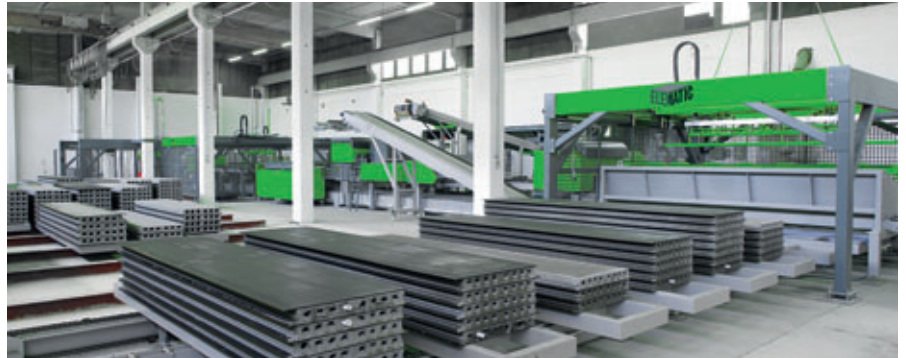
Elementi di parete Acotec, freschi, lungo il percorso verso lo stoccaggio di maturazione.
