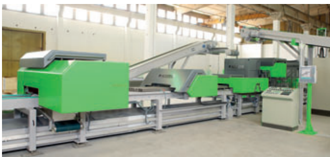
Il cuore della linea Acotec è un estrusore fisso e una sega per dividere gli elementi di parete.
