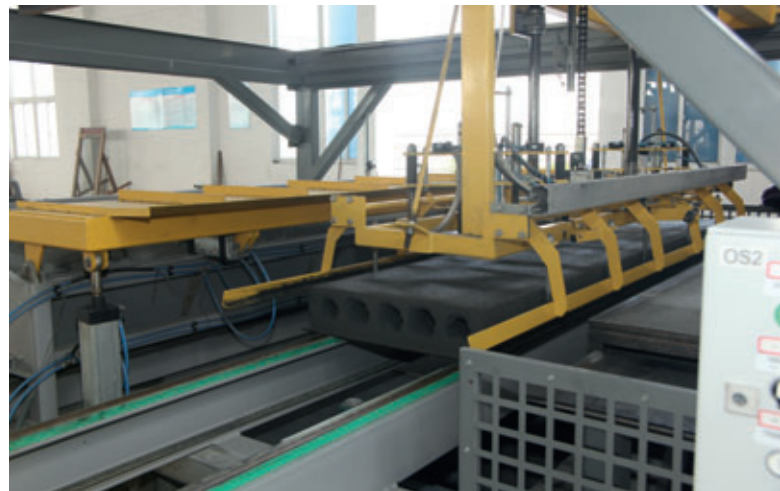
Nella stazione di palletizzazione della linea Acotec si impilano gli elementi di parete, freschi, insieme a un pannello di appoggio in pile da 6-10 elementi ciascuna per la maturazione preliminare.
