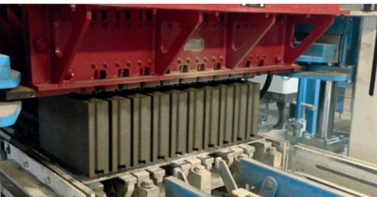
Fabrication de blocs complexes avec le système de type rainure et languette horizontal et vertical
