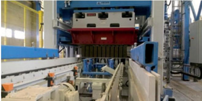
Machine à hautes performances Hess RH 1000-2 avec chariot électrique de remplacement de moule
