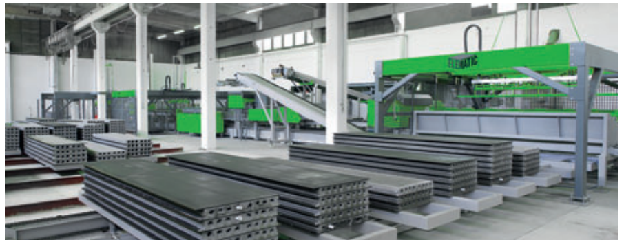
Éléments de paroi Acotec fraîchement coulés en route vers les rayonnages de durcissement.
