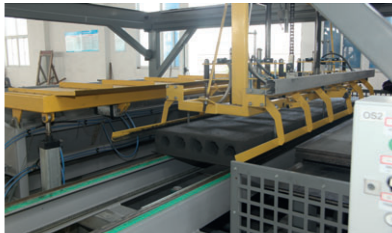
Sur la station de palettisation de la ligne de production Acotec, 6 à 10 éléments de parois frais et leurs planches de support sont empilés l'un sur l'autre pour durcissement préalable.
