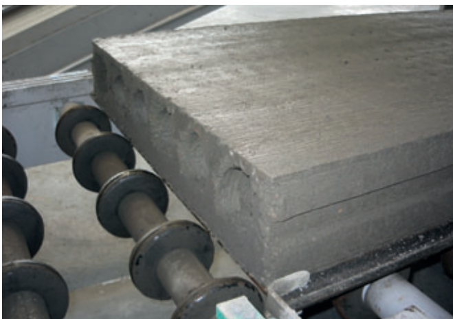
Cloison de séparation Acotec fraîchement découpée en route vers la palettisation
