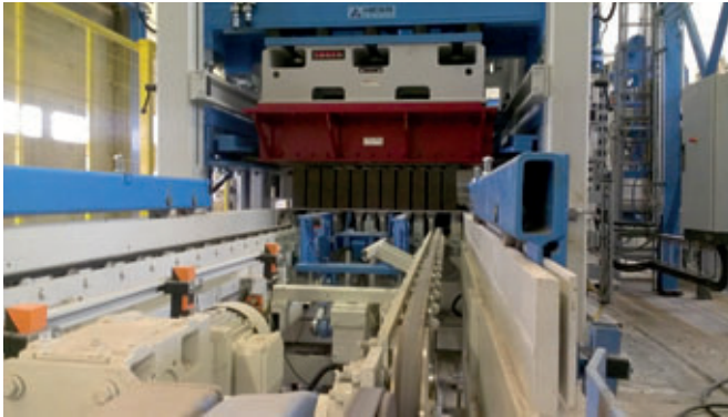
Máquina de alto rendimiento RH 1000-2 de Hess con carro eléctrico de cambio de molde
