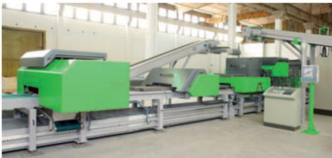
El corazón de la línea Acotec son una extrusora fija y una sierra para separar los elementos de pared.
