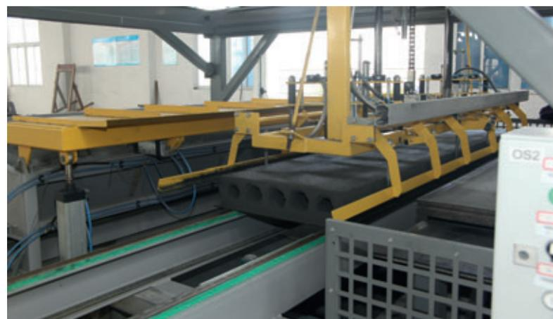
*En la estación de paletización de la línea Acotec se apilan los elementos de pared frescos y una bandeja en pilas de 6-10 elementos para su fraguado previo.*
