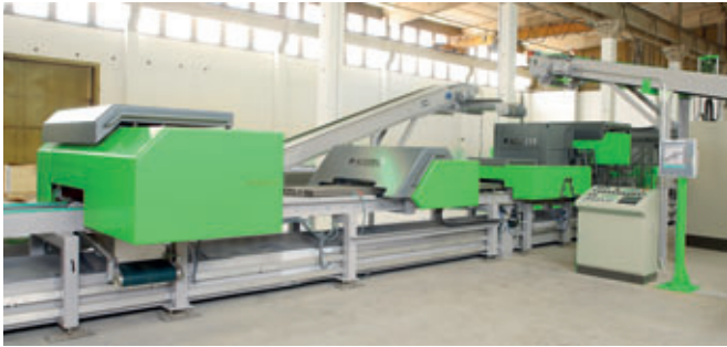
Das Herz der Acotec-Linie ist ein feststehender Extruder und eine Säge zum Trennen der Wandelemente.
