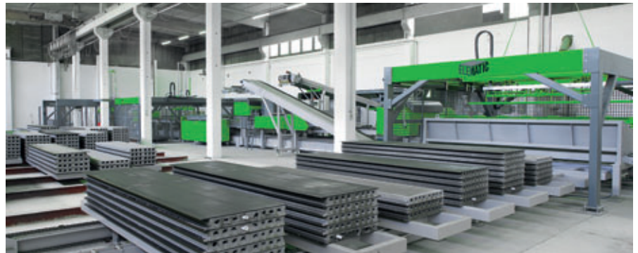
Frische Acotec-Wandelemente auf ihrem Weg zur Aushärtungslagerung.
