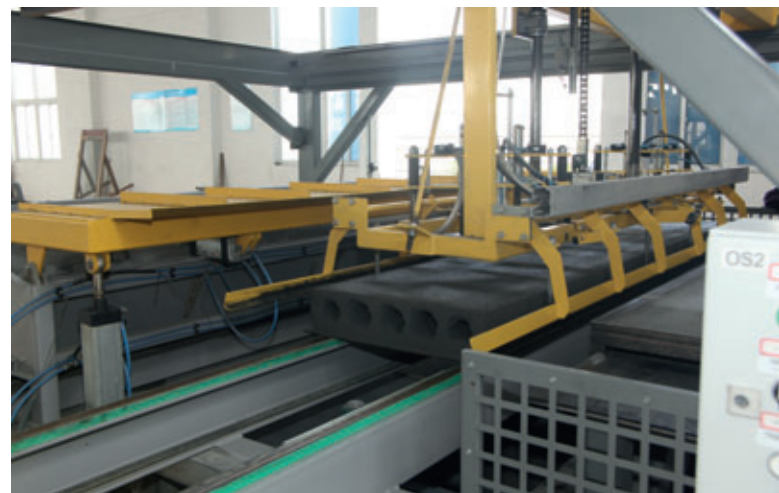
An der Palettierstation der Acotec-Linie werden die frischen Wandelemente samt einer Unterlagsplatte in Stapeln zu je 6–10 Elementen zur Voraushärtung gestapelt.
