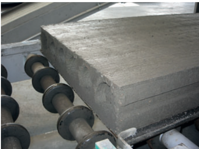
Frisch getrennte Acotec-Wand auf dem Weg zur Palettierung
