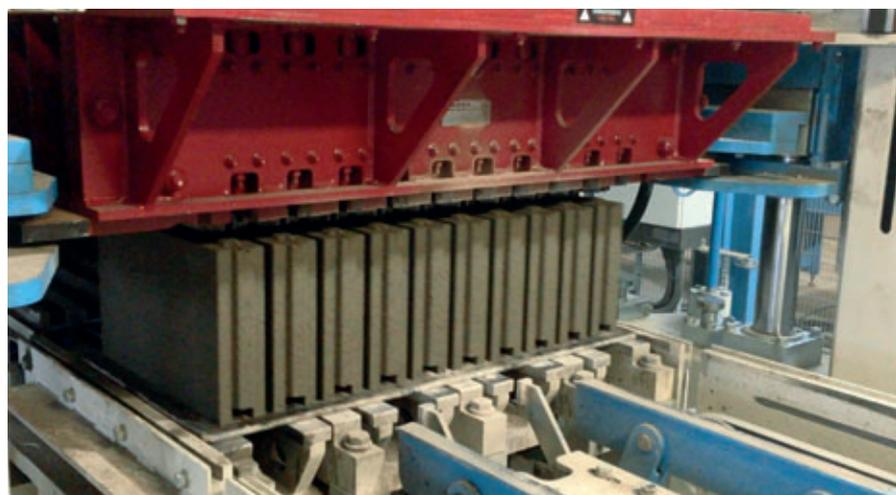
Komplexe Steine mit horizontalem und vertikalem Nut-Feder-System
