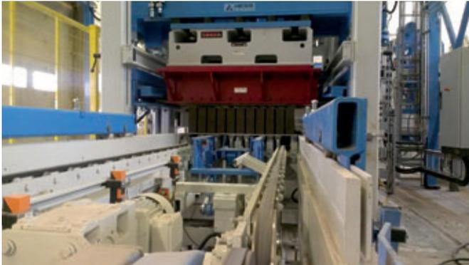
Hess-Hochleistungsmaschine RH 1000-2 mit elektrischem Formwechselwagen
