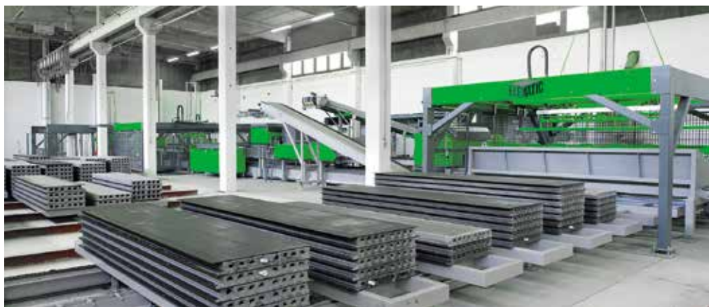
新出的 Acotec 墙板整齐码放，便于夜间固化
