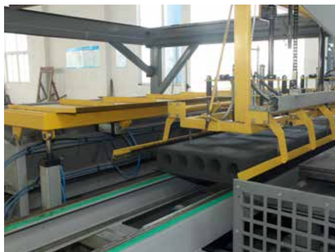
在 Acotec 生产线的堆放站点里，带有底盘的新制墙板被堆放在 6-10 个堆栈里，以便随后进行预固化处理
