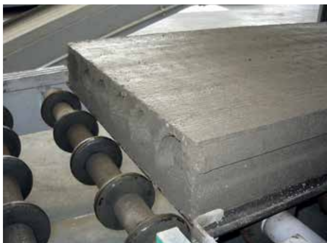
刚完成切割的 Acotec 墙板将被送至堆栈
