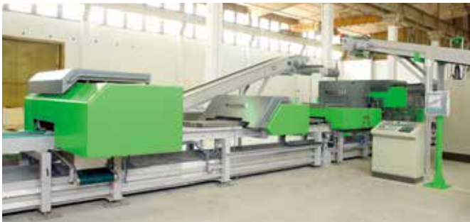
Acotec 生产线的核心由一个固定式挤压机以及用于动态切割产品的锯组成
