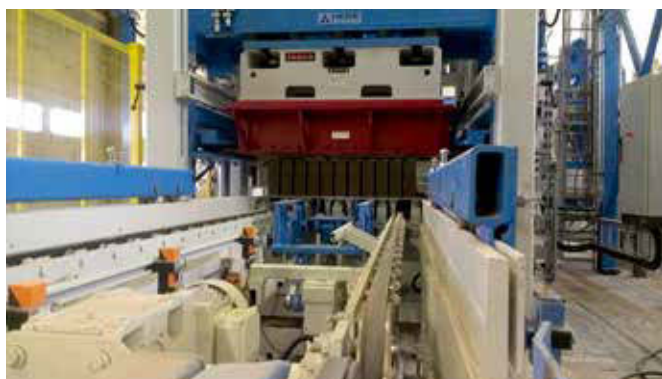
Hess RH 1000-2 高性能机器以及电动换模装置
