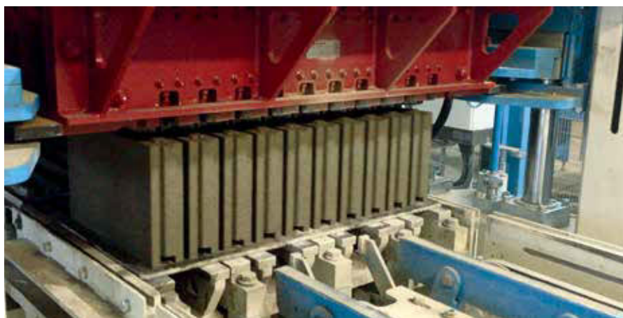
装有一个水平和垂直的榫舌和凹槽系统的复合砌块
