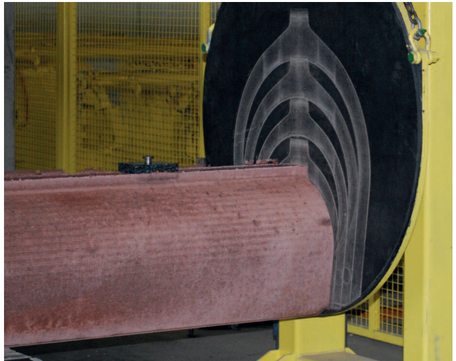
Вибролитая труба из самоуплотняющегося бетона проходит испытания на герметичность в условиях полностью автоматизированного производства перед финальным утверждением
