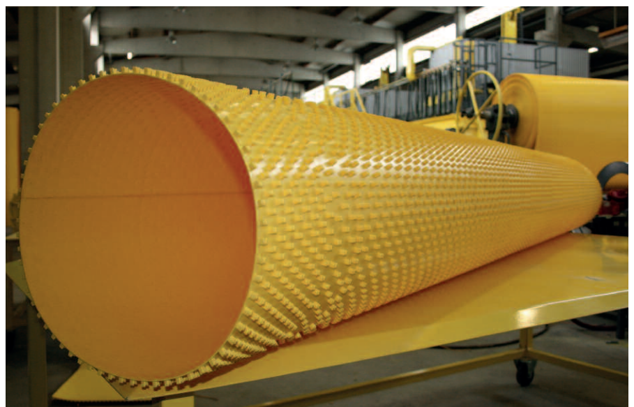
Облицовка HDPE изготавливается в виде цилиндров с различными видами крепления с внешней стороны – для надежного сцепления в с бетоном
